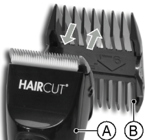
Afbeelding 6: de opzetkam plaatsen en verwijderen.
