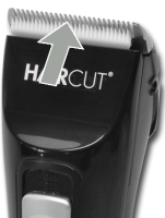
Abbildung 7: Abnehmen des Schneidkopfs durch Drücken.
